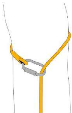
Fig. 2 - Strozzo diretto della fune
