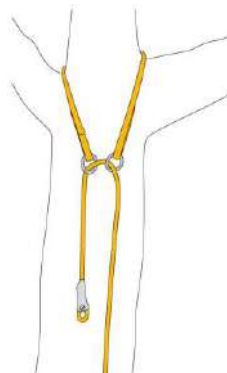
Fig. 8 - Ancoraggio passante per corda raddoppiata
